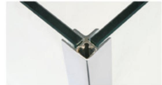
Recommandations : Etanchéité - équerres, embouts, coupes et extrémités doivent être siliconés (neutre)
