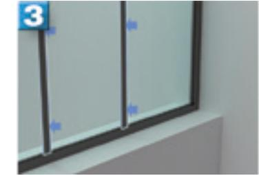
Fixation des montants plats sur le verre ou sur la jonction des volumes avec double face ou silicone si milieu humide
